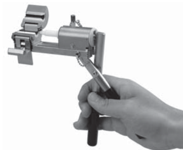
Расширение трубки экспандером
